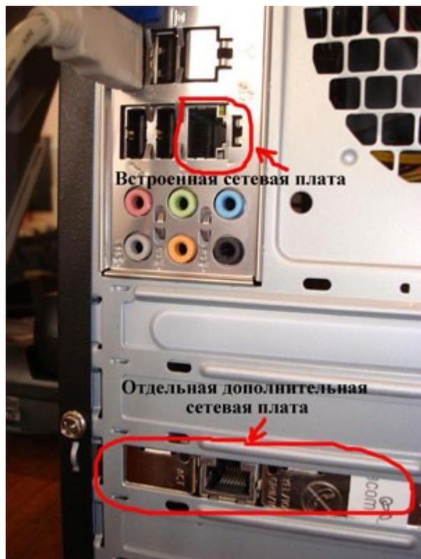
Внешний вид разъёма встроенной и дополнительной сетевой плат на задней панели системного блока.
